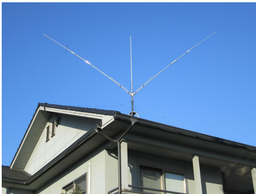
アマチュア無線のシンボル アンテナ群 (V型になっているのが HF 帯に対応、垂直部分が 144MHz、430MHz 帯に対応している。)
